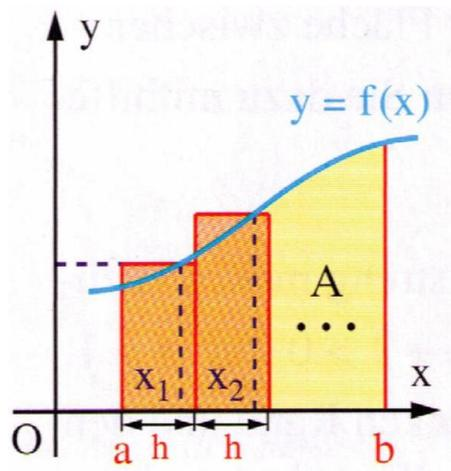
**Abbildung 1:** Näherung der Fläche unter dem Funktionsgraphen durch Rechtecke.
