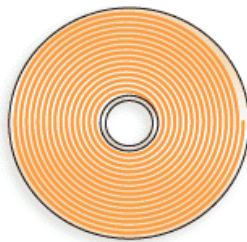
Abbildung 2: Spiralform der Abfolge der Pits und Lands
