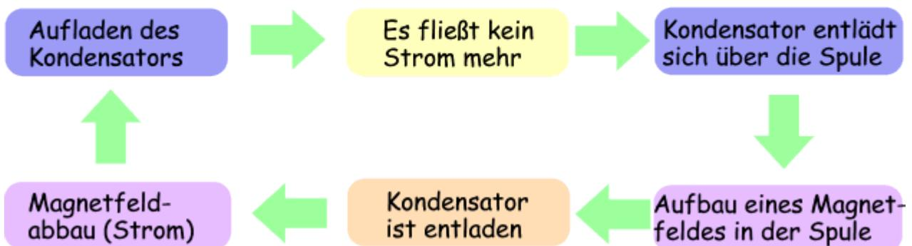
Für die mathematische Beschreibung betrachten wir nun die Ladung am Kondensator  $Q(t)$ , durch die auch die Spannung am Kondensator festgelegt ist:  $U_C(t) = \frac{Q(t)}{C}$ . Die Spannung an der Spule ist durch die Beziehung  $U_L(t) = -L \cdot \dot{I}$  gegeben. Bei geschlossenem Schalter haben sie den gleichen Wert („Spannung in der Parallelschaltung gleich“). Daraus folgt eine Differentialgleichung für  $Q(t)$ , die wir bereits aus der Behandlung des Federpendels kennen:
