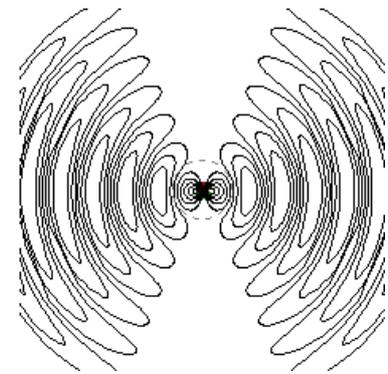
Die linke Abbildung zeigt die Feldlinien des abgestrahlten E-Feldes. In der Mitte befindet sich der (senkrechte) Dipol. Natürlich braucht die Schwingung an der Dipol-Antenne eine ständige Erregung, durch einen sog. Erregerschwingkreis!
